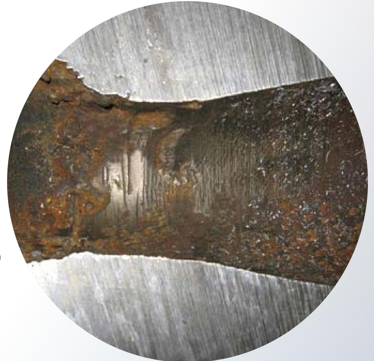
Reproducido de Science Direct, Volumen 1, Edición 3, S.M.R. Ziaei, A.H. Kokabi, M. Nasr-Esehani, Caso Práctico de Agrietamiento por Corrosión bajo Tensión inducida por Sulfuros, y Rotura del Cuerpo de la Válvula de Control de la Cabeza de Pozo A216-WCC inducida por Hidrógeno, Páginas 223-224, Julio de 2013 con permiso de Elsevier.
